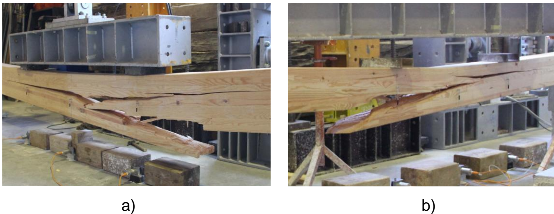
Figura 2 – Rotura apresentada pelas vigas após ensaio de flexão: a) viga de secção 17 x 31 cm 2 b) Viga de secção 17 x 21 cm 2
